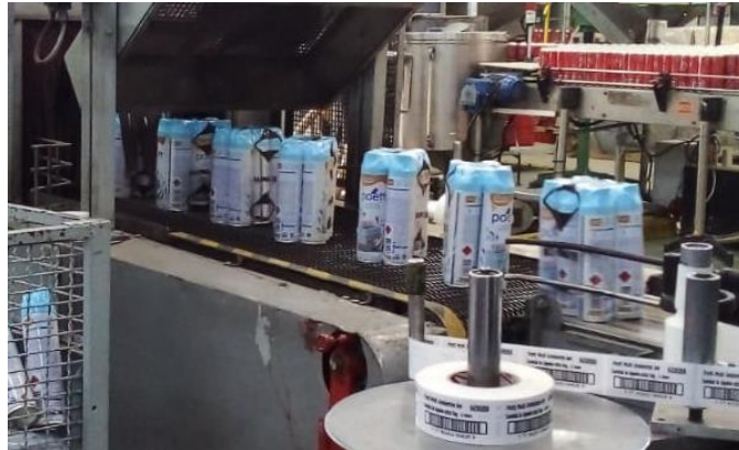
Imagen 8: Salida de envolvedora termocontraible
