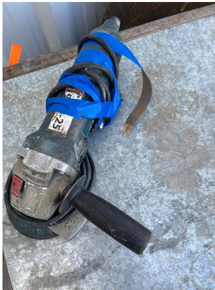
Imagen N°9: Carcasa en mal estado, cubierta con cinta. Fuente: CP/ Cassanelli Pamela, 2025.
