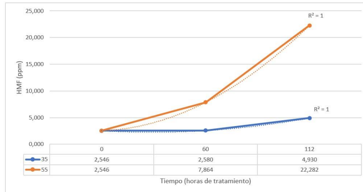
Figura 80 Comportamiento del pardeamiento acelerado del mosto virgen según contenido de HMF hallado en muestras de pH 4,2
