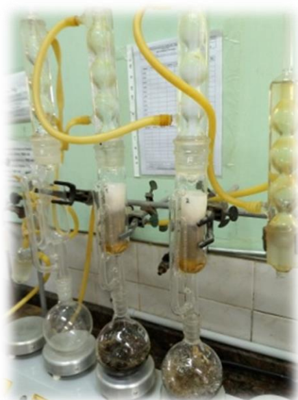
Figura 18: Equipo Soxhlet para retirar los componentes solubles en agua y etanol del EU.
