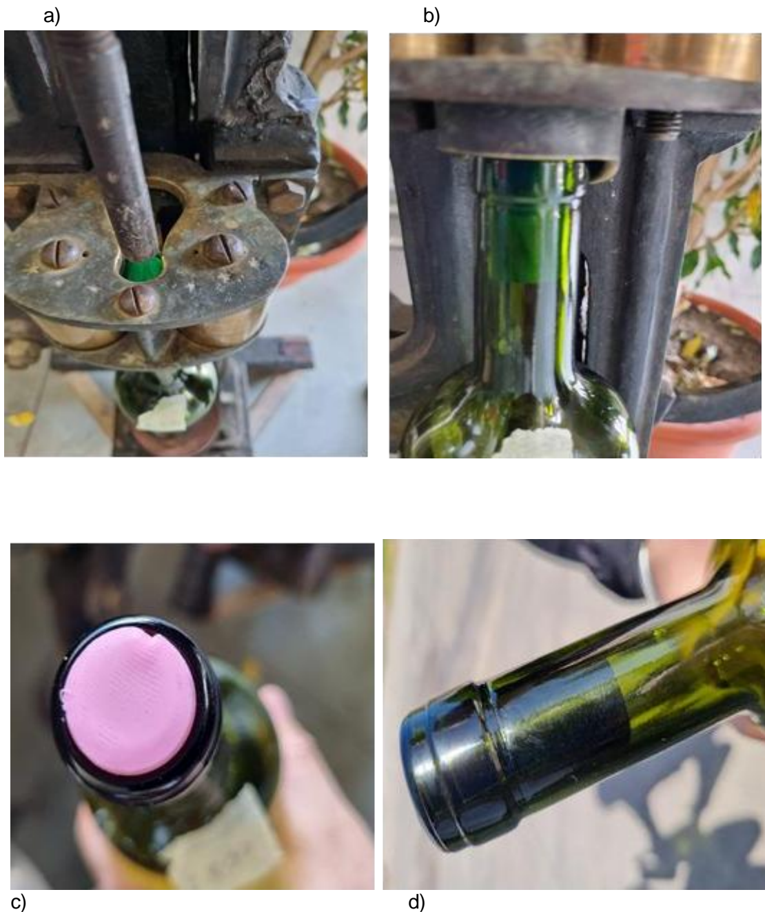
Figura 11; a) Ingreso del tapón y compresión. b) Ingreso al cuello de la botella. c) Vista superior luego del tapado. d) Vista lateral del tapón dentro de la botella.
