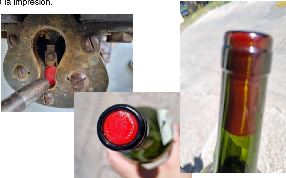
Figura 15: a) Ingreso del tapón y compresión. b) Vista superior luego del tapado. c) Vista lateral del tapón dentro de la botella.
