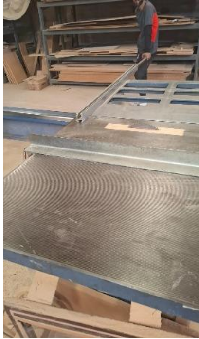
Figura N° 5 Escuadradora con sierra de banco. Fuente: R.M AÑO 2025
