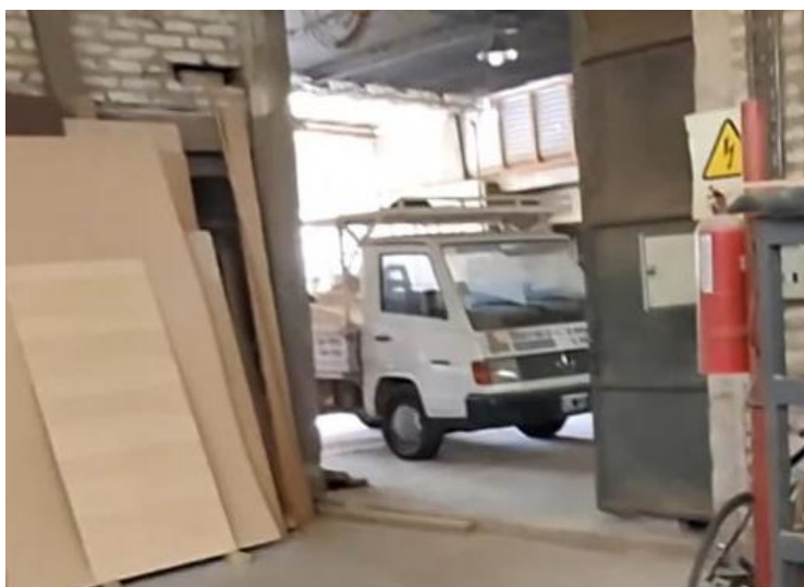
Figura N° 5: portón del taller de carpintería obstaculizado por tablas de madera. Fuente: R.M 2025
