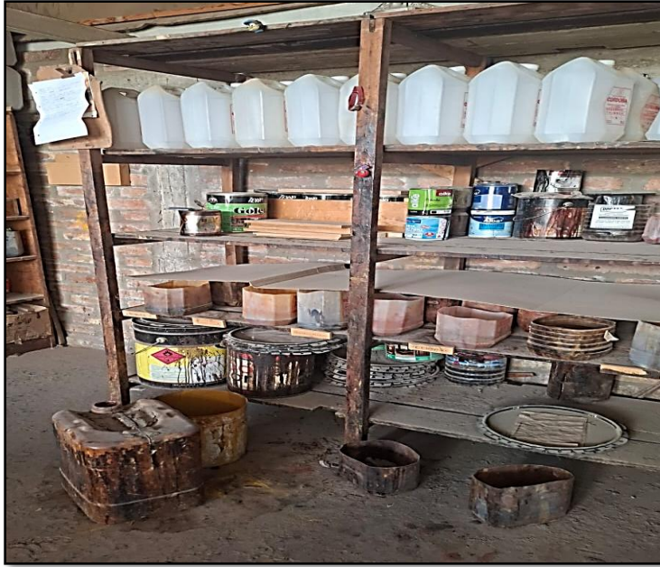
Figura N°1: estantería actual con productos químicos desordenados, destapados y no identificados. Fuente: R.M 2025
