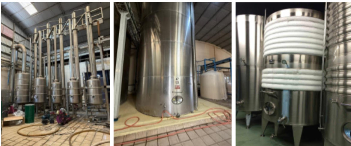
Figura 6: a) Pasteurizador, b) Tanques de acero inoxidable para conservación de mosto concentrado y c) Tanques de acero inoxidable con cámaras de refrigeración de Bodegas y Viñedos Benedetti (Fotografías Propias)
