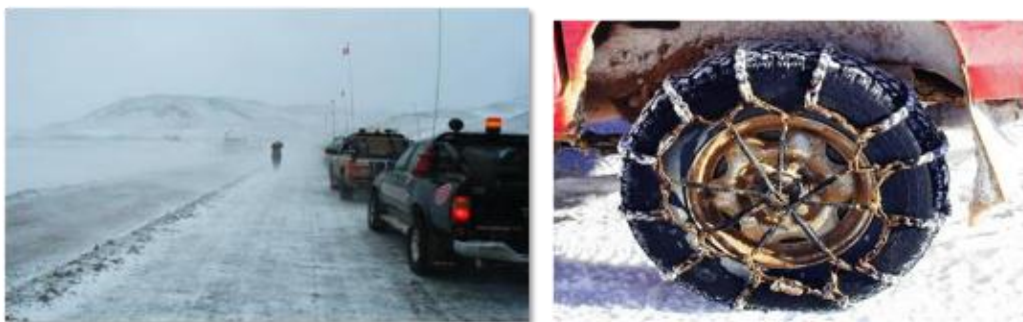
Fig. 18. Colocación de cadenas
