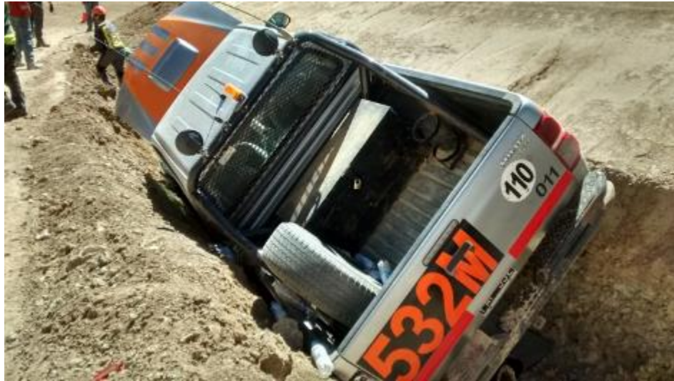
Fig. 9 Caída de camioneta de la empresa Milicic en zanja de anclaje. Camino sin berma de contención
