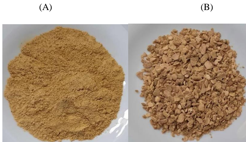
Figura 12: (A) Tamizado Fino - Harina de Cáscara de Naranja. (B) Tamizado Grueso. Ambas muestras fueron obtenidas con una procesadora doméstica.
