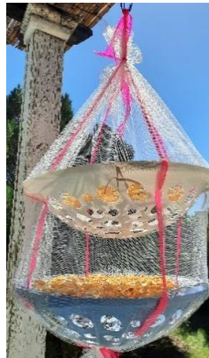
Figura 16: Prototipo de secadero solar construido para las pruebas.
