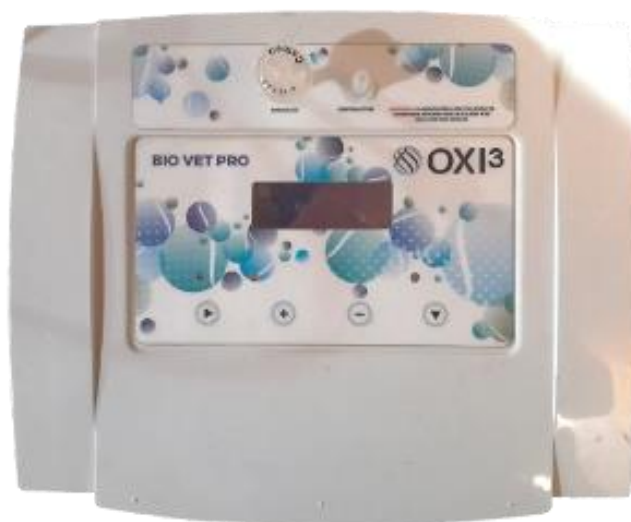
Fig 1. Generador de Ozono BIOVET PRO OXI3, utilizado para el presente trabajo. Imagen de autoría propia
