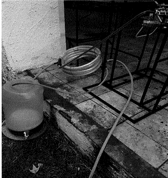
Figura 32: Enfriado del mosto.
