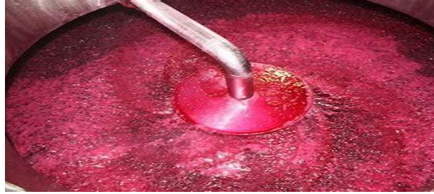
ILUSTRACIÓN 16 REMONTAJE CON CHALLADOR
